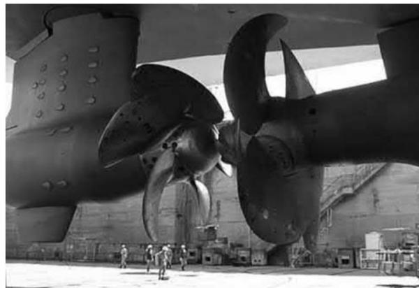
**Figura 1.6.** Sistema de propulsión contra-rotante se observa como una de las hélices es más pequeña. Adaptado de Carlton (2018) [24]
