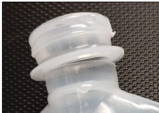
Fig. 13. Fotografía de envase con cuello grafilado
