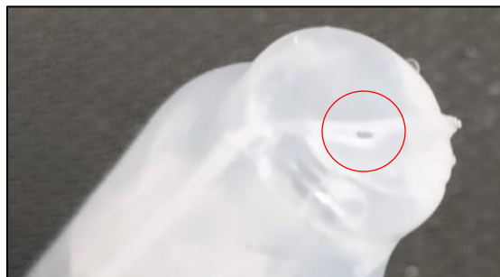
Fig. 8. Fotografía de envase con la base rota
