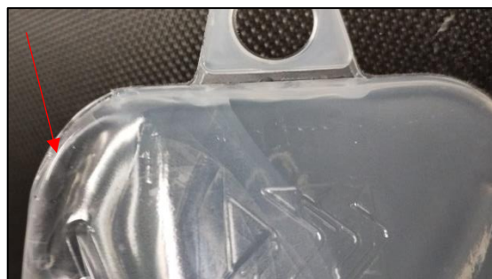
Fig. 10. Fotografía de envase con debilidad en la base
