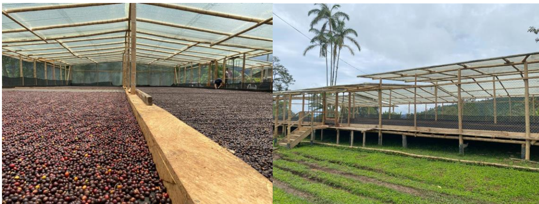
Figura 38. Sistema de secado, vía solar, método marquesina
