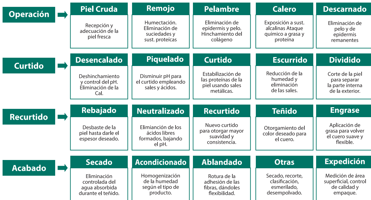
Figura 1. Flujograma del proceso de curtido Fuente: (Adaptado de Beghetto et al. , 2014; Cooman et al. , 2003)
