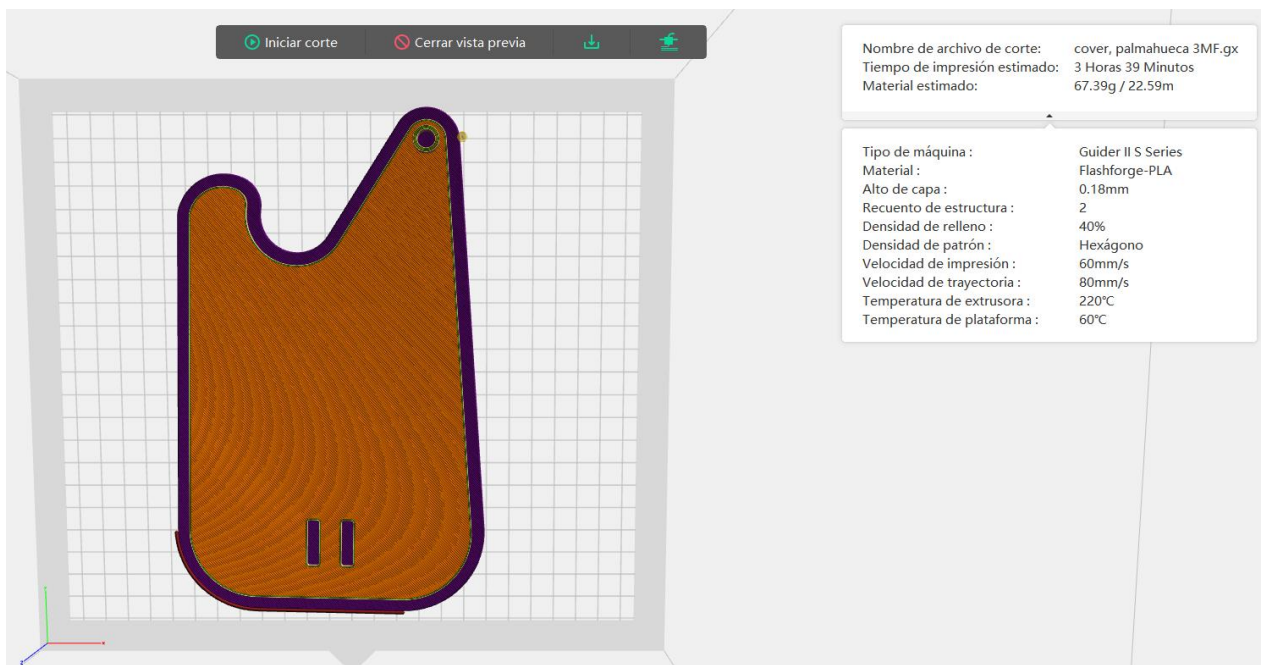
Fig. 9 Parámetros de impresión 3D de la cubierta en el software FlashPrint.
