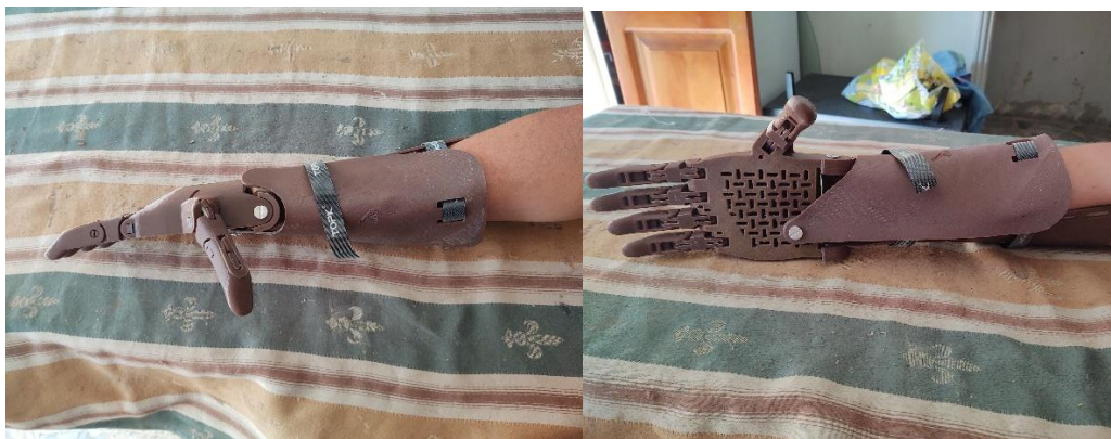
Fig. 12 Cubierta final con velcros colocada al beneficiario.
