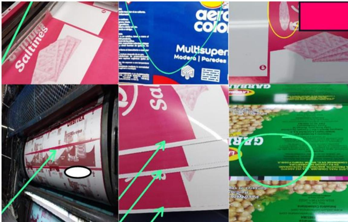
*Ilustración 4 Defectos de impresión*
