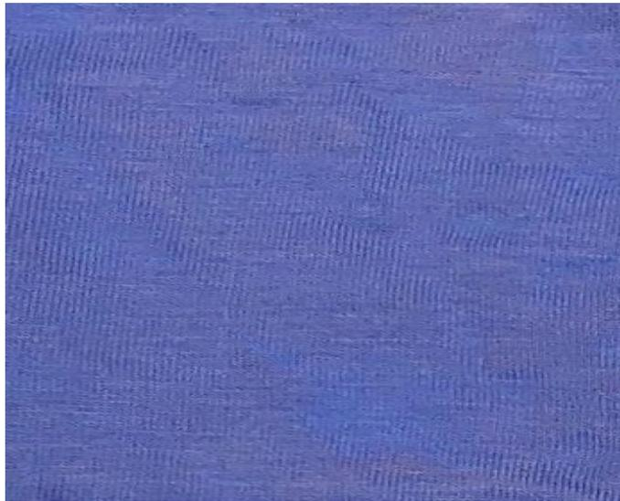
Fig. 1. Fragmento de tela afectado por hidrólisis catalizada por ácido
