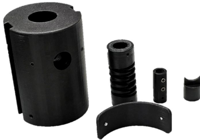
*Figura 24: Componentes del sistema mecánico fabricados en CCFR-PLA.*
