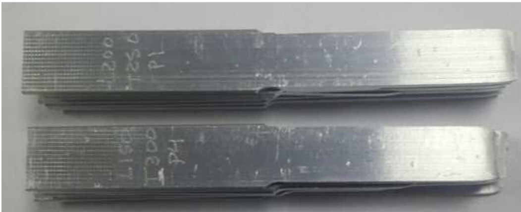
Figura 28: Probetas falladas por ensayo de tracción.
