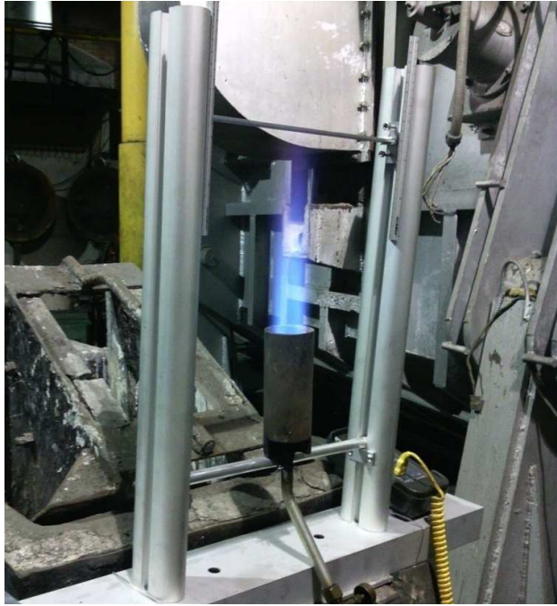
Figura 33. Graduación de altura de llama con probeta (distancia 200mm) en el centro del dispositivo para ensayo.
