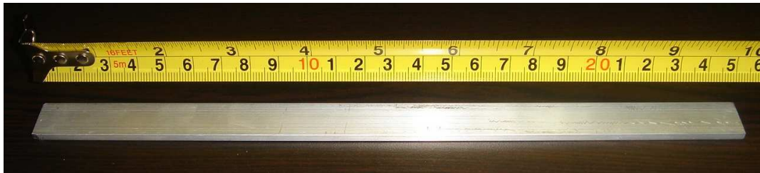
Figura 25: Muestra aleatoria de perfil extruido para ensayos: Longitud 250mm.
