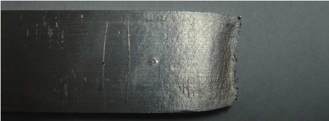
Figura 27: Punto de indentación WEBSTER en probeta fallada.
