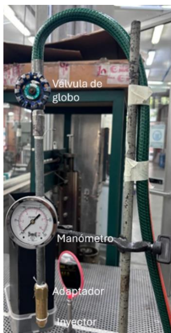
Fig. 40. Montaje del sistema de inyección.
