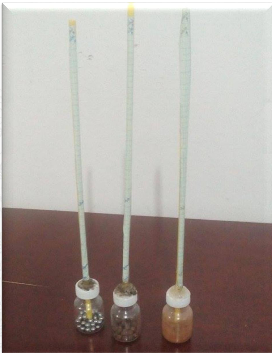
Foto 12: Areómetros con las sustancias representadas en su escala.
