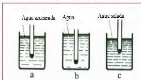
Ilustración 2: Representación de grados de flotabilidad utilizando diferentes medios y un cuerpo como referencia.
