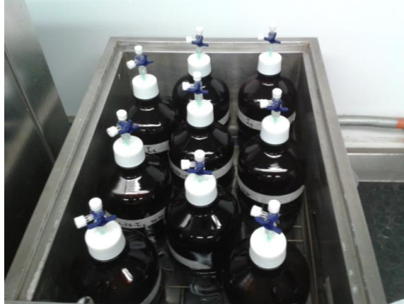
Figura 2. Montaje experimental utilizado en los ensayos de PMB.
