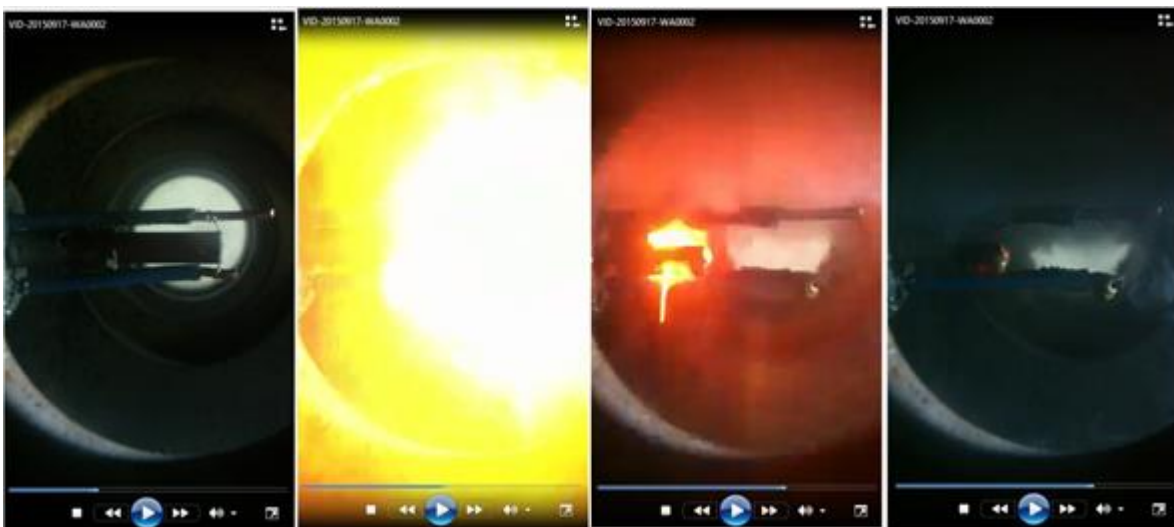
Figura 4.4 Combustión de una muestra MU0875-02 de propelente sólido
