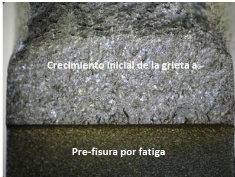
Figura 6.12. Superficie de fractura de una muestra sometida al ensayo de CTOD sin carga de hidrógeno correspondiente al material en estado TT1300.
