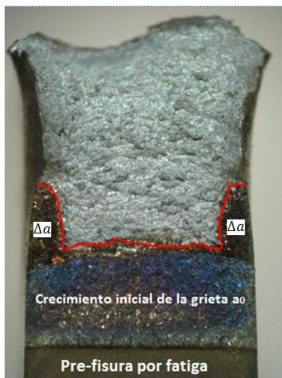
Figura 6.13. Superficie de fractura de una muestra sometida al ensayo de CTOD cargada previamente con hidrógeno correspondiente al material en estado TT1300. El área demarcada por la línea roja corresponde a la región de crecimiento estable de la fisura \Delta a .
