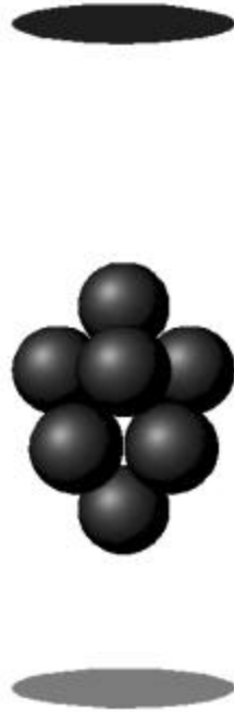
Figura 1. Modelo de diez esferas empleado para determinar el funcionamiento de un lecho empacado simplificado, sometido a convección forzada transitoria utilizando CFD y pruebas experimentales.
