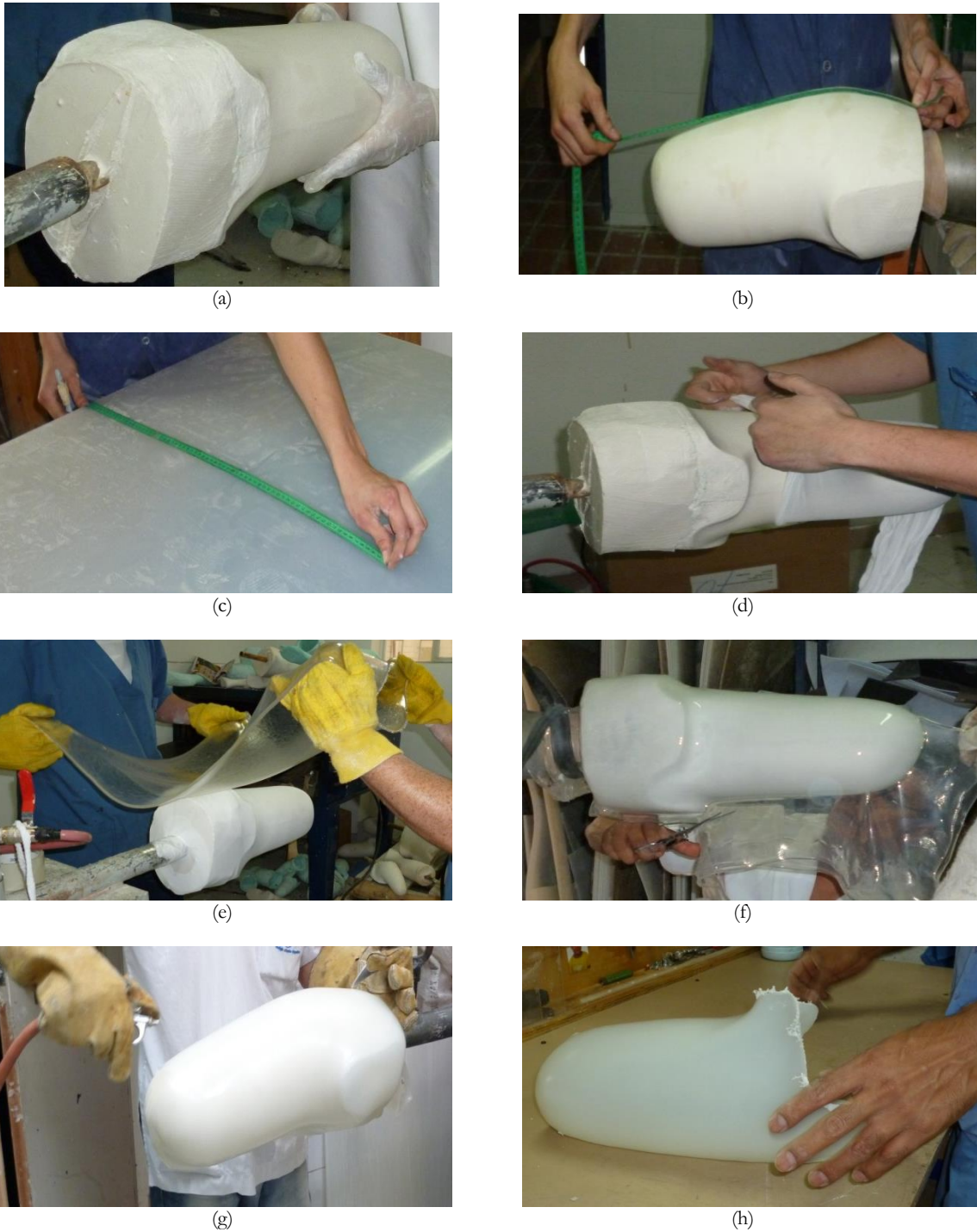
Figura 13 Proceso de fabricación de Sockets para amputados transfemorales en Colombia: (a) Positivo en yeso del muñón del paciente, (b) Toma de medidas del modelo, (c) Medidas de lámina de Polipropileno para el corte, (d) Calzado de media de Nylon en el positivo, (e) Recubrimiento del modelo con lámina de Polipropileno caliente, (f) Termoformado del Socket, (g) Enfriamiento y (h) pulido y acabado final Fuente: Grupo Diseño Mecánico
