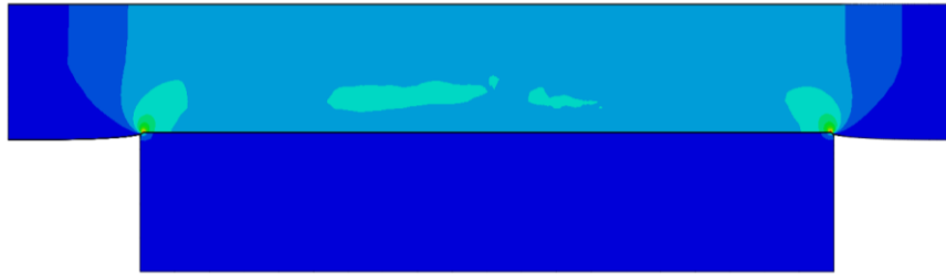
Figura 34 Contacto de probeta con perfil superficial por acabado con papel abrasivo 360 sobre la piel.
