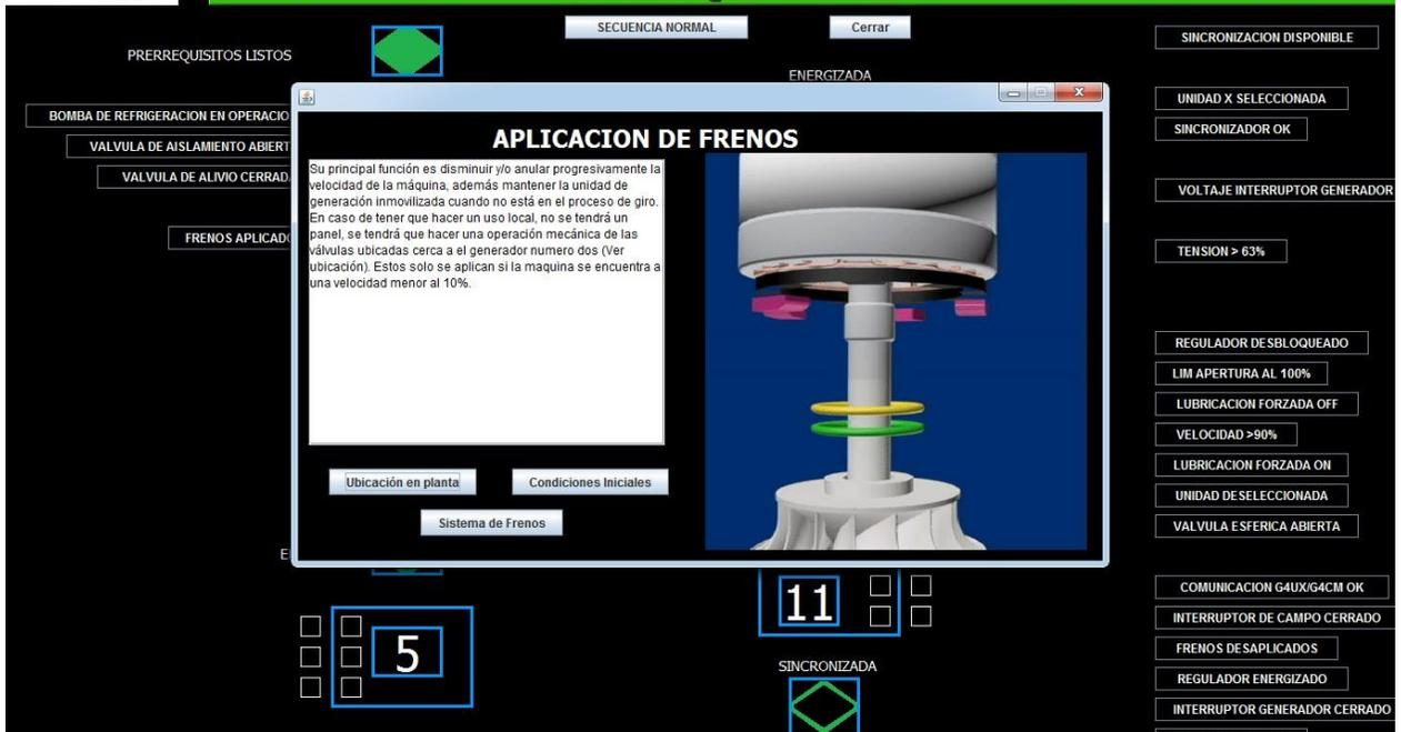
Imagen 4: Aplicación de frenos con imagen 3D en movimiento.
