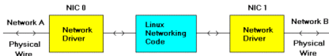
Figura. 11 Operación de Linux como un Router [13]
