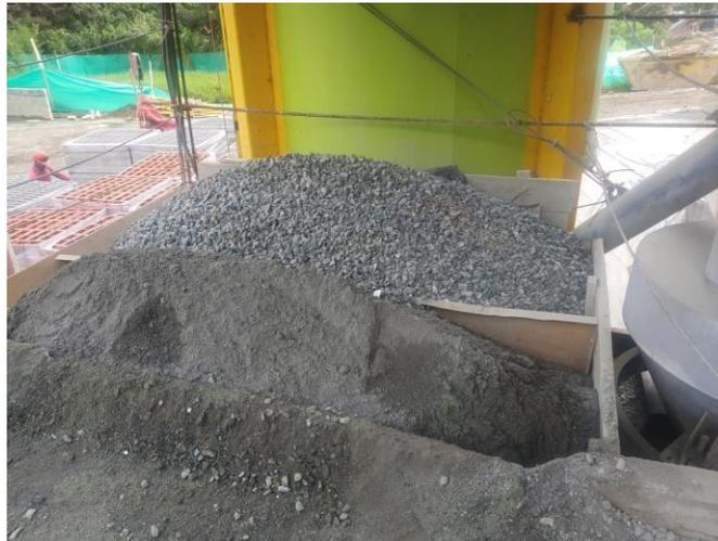
**Figura 14.** Tolvas de la concretadora Domat serie DPM 30 respectivamente abastecidas con agregado fino y grueso. **Fuente:** Propia
