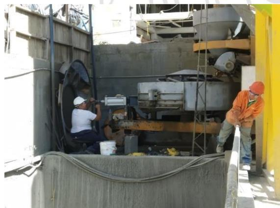
**Figura 13.** Mantenimiento de la concretadora Domat serie DPM 30. **Fuente:** Propia.
