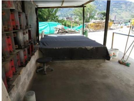
**Figura 7.** Taller de concreto para elaborar especímenes de prueba y tanque de curado. **Fuente:** Propia
