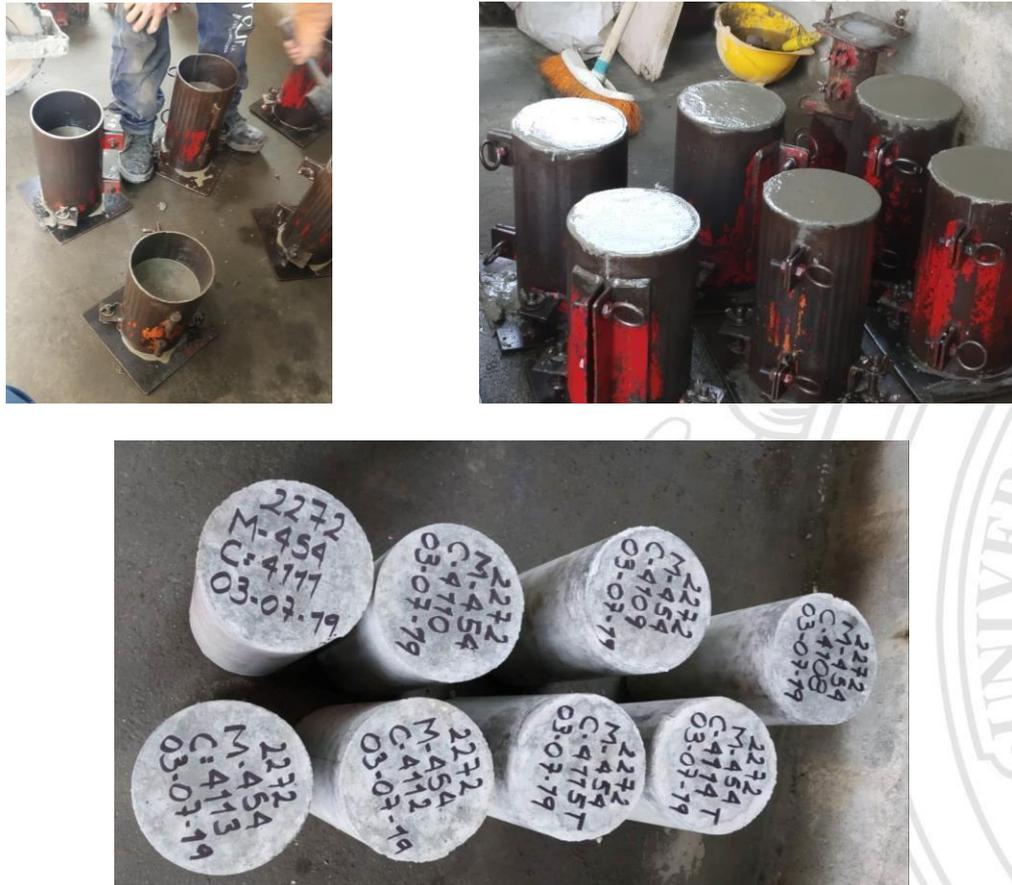
**Figura 17.** Elaboración de especímenes de concreto. **Fuente:** Propia.
