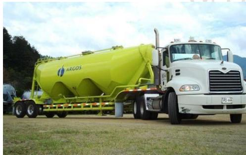
**Figura 3.** Vehículo cisterna para transportar y abastecer el cemento a granel. **Fuente:** Argos
