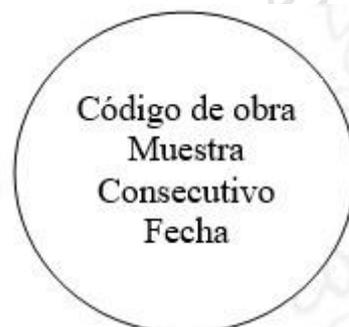
**Figura 18.** Formato para marcar los especímenes de concreto. **Fuente:** Especificaciones Vivenza
