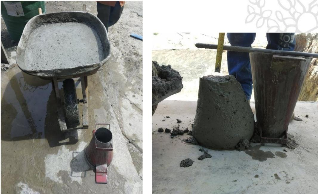
**Figura 15.** Ensayo de asentamiento realizado en la obra Vivenza. **Fuente:** Propia.
