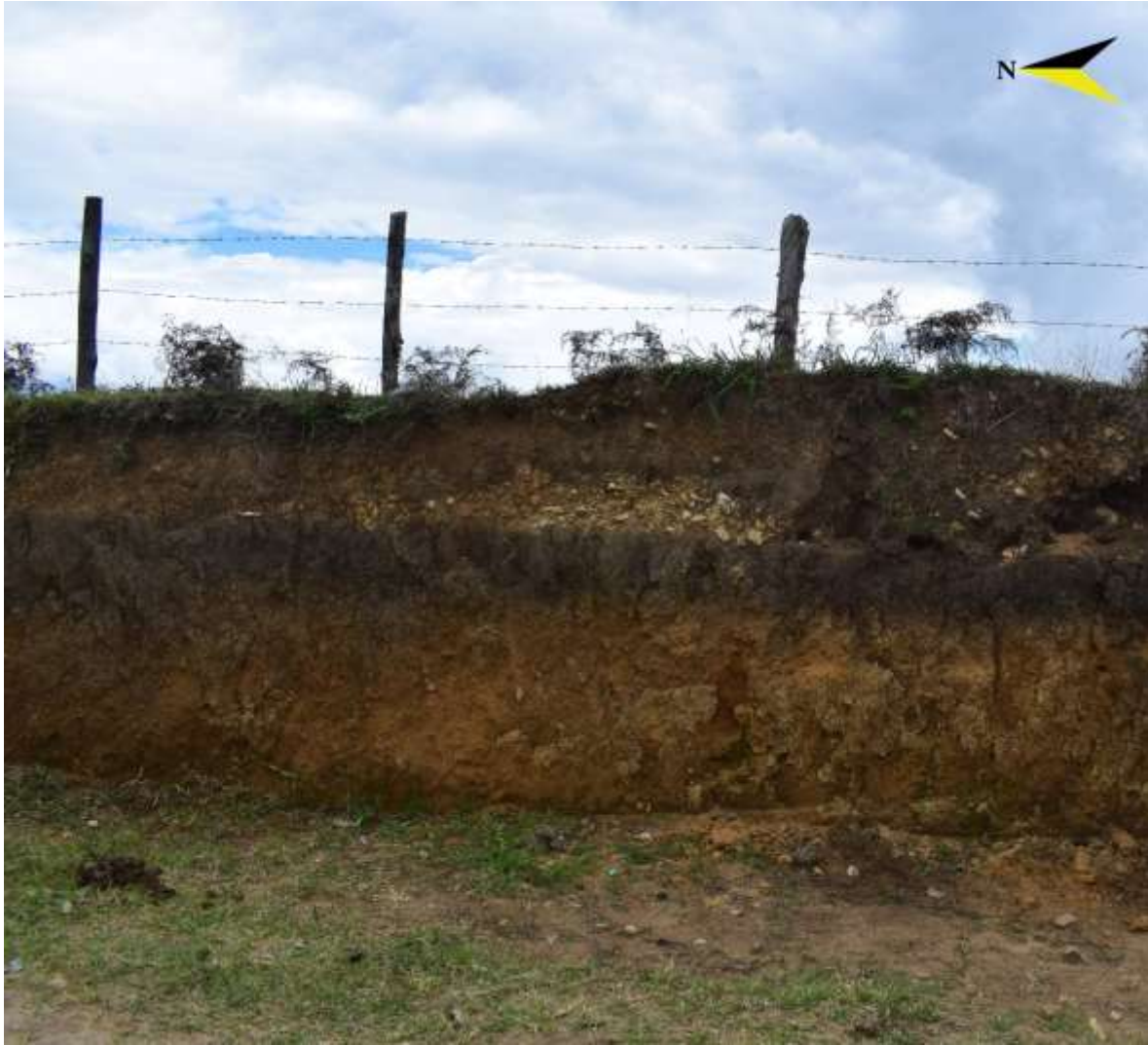
Fotografía 85. Sitio Último Tiro. Perfil de suelo con horizonte enterrado de color negro. Fuente: Elaboración propia.
