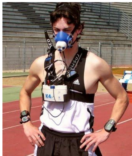
Figura 8. Ejemplo de condiciones de medida de consumo de oxígeno utilizando un equipo portátil, el k4b2 de la firma Cosmed (imagen tomada de la página del fabricante: http://www.cosmed.com/k4b2 )
