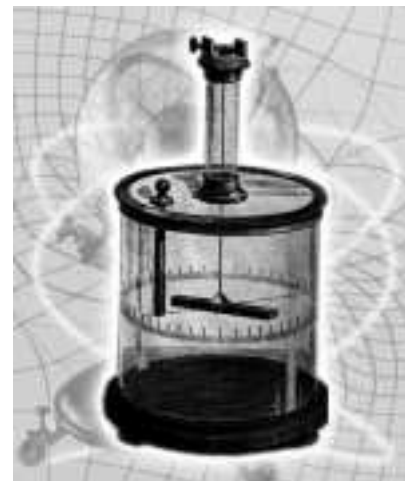
Con la balanza de Coulomb es posible medir la fuerza entre cargas eléctricas.
