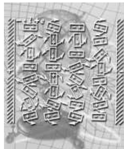
En un dieléctrico los dipolos elementales se reorientan en presencia de un campo eléctrico.
