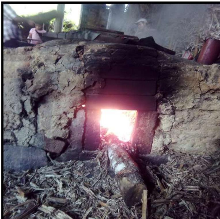
**Fotografía 27:** Horno encendido en el que se cocina el guarapo.
