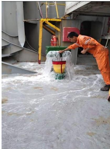
**Figura 3.** Ejemplo de toma de muestra de agua de lastre de donde se tomaron muestras directas.
