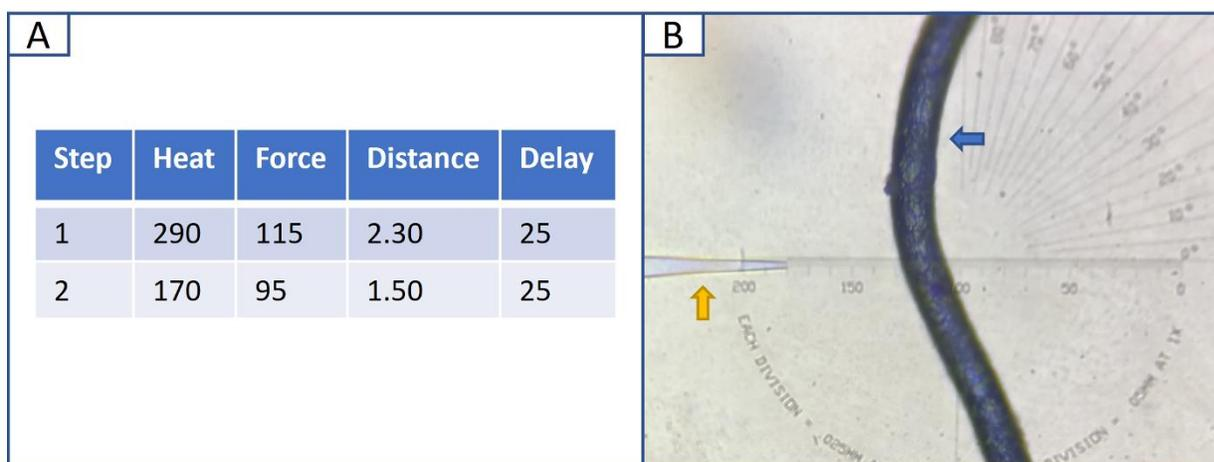
**Figura 10. Preparación de micropipetas.** **A.** Protocolo para el fundido de capilares utilizado en Pul-100, WPI. **B.** Vista en microscopio de luz de micropipeta y filamento de microforja durante el proceso de fundido. La flecha color azul señala el filamento que es calentado por la microforja, la flecha amarilla señala la micropipeta ubicada a 50  $\mu\text{m}$  del filamento.
