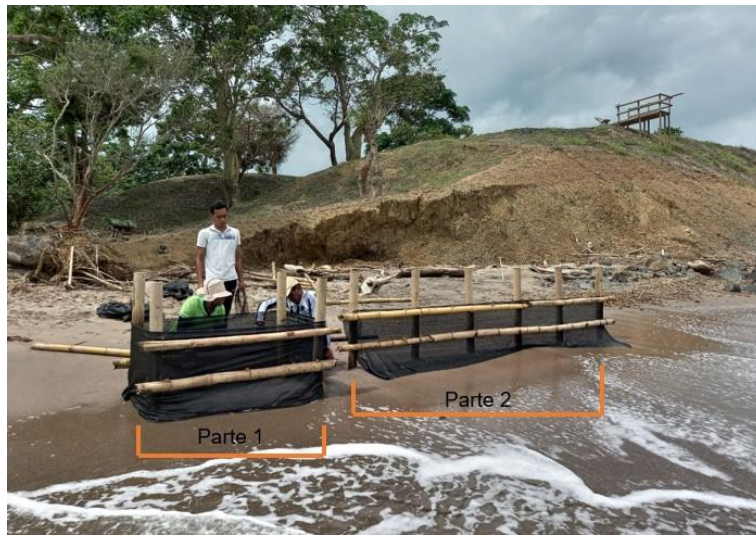
Figura 4. Configuración de la estructura permeable piloto instalada en el Laboratorio costero de la UdeA
