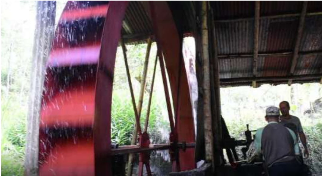
Figura 15. Trapiche con rueda Pelton en la vereda El Bosque. Viana (2018)
