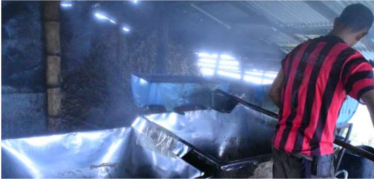
Figura 20. Hornero o guarapero usando el remellón para pasar el líquido de fondo. Entable familia Morales, vereda Venecia. Viana (2018)
