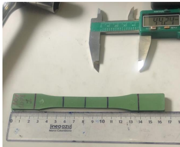
Fig. 20. Probetas para flexión. Medición de ancho y espesor.
