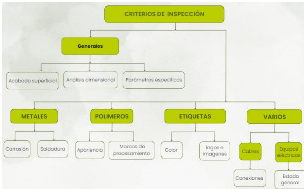
Figura 2. Criterios de inspección para las muestras
