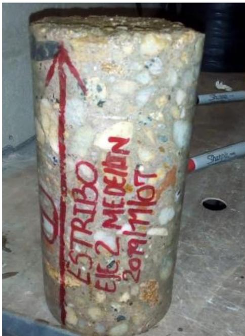
**Figura 13.** Imagen núcleo extraído para el ensayo de compresión del concreto.
