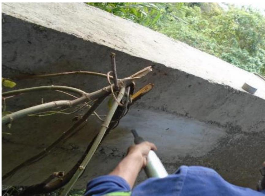
*Figura 15. Imagen ensayo de Esclerometría en losa, vigas y riostras.*
