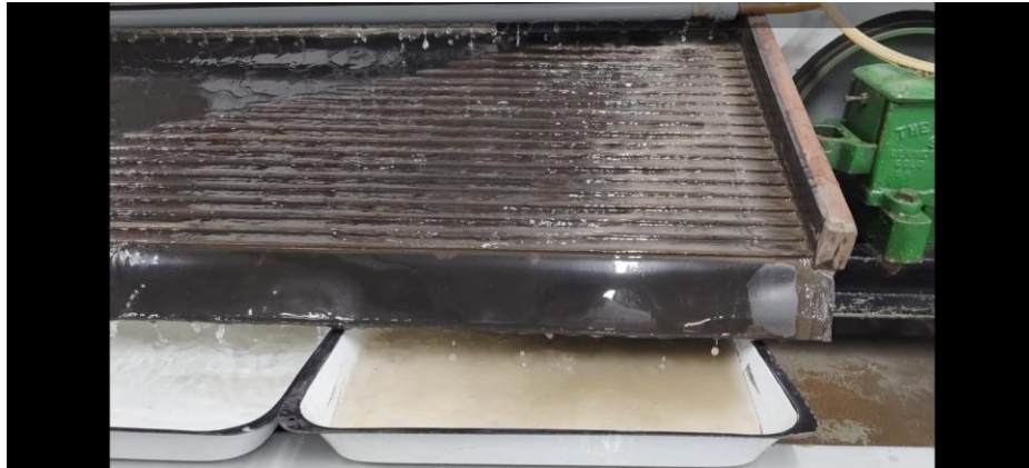
Fig. 18. Condición en la mesa wilfley con un ángulo de 18°
