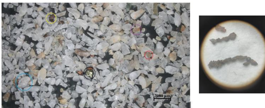
Fig. 13. Caracterización de las diferentes especies mineralógicas por el estereoscopio
