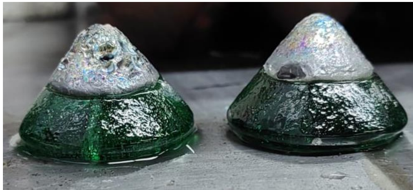
Fig. 15. Botones de plomo del ensayo al fuego
