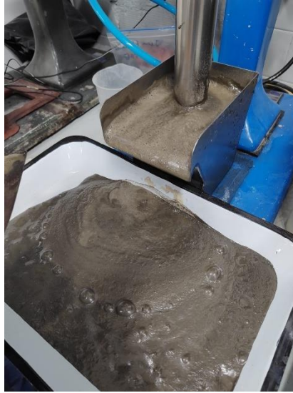
Fig. 20. Concentrado en el proceso de flotación aun pH de 7
