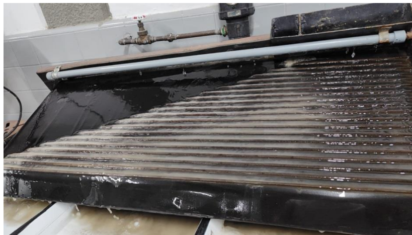
Fig. 19. Condición en la mesa wilfley con un ángulo de 14°
