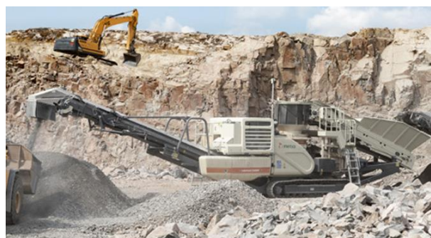
Figura 22. Trituradora de cono Lockotrack LT200HP
