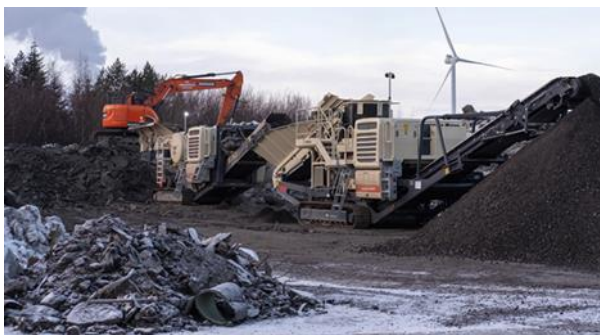
Figura 21. Trituradora de mandíbula Lockotrack LT106
