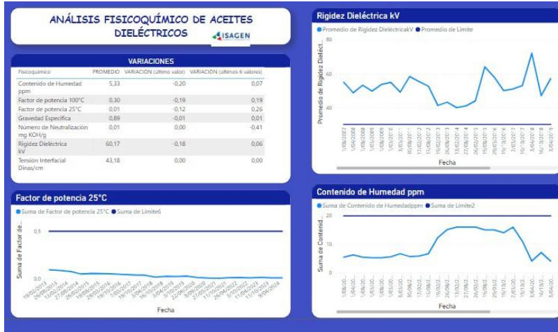
Figura 18. Análisis fisicoquímicos de aceites dieléctricos
