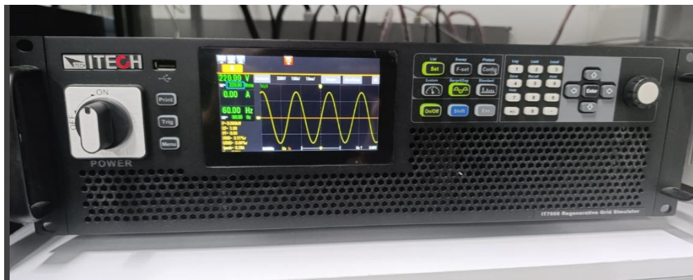
Fig. 12. Emulador de red Itech IT7900 funcionando con los parámetros para una red 220V 60Hz.
