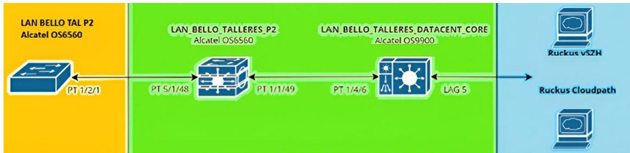
Fig. 4. Montaje Laboratorio Pruebas con Switch Alcatel.
