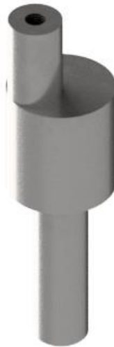
Ilustración 17. Concepto de diseño de eje excéntrico libre.
