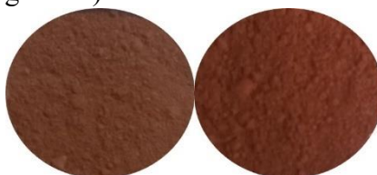
Figura 12. Foto de las akaganeitas después de secadas y molidas por mortero, a la izquierda la akaganeita pura y a la derecha la akaganeita preparada con EDTA.
