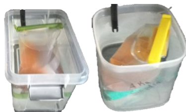
Figura 11. Foto de las sustancias en su etapa de diálisis, a la izquierda akaganeita sintetizada solo con agua, a la derecha la akaganeita sintetizada con EDTA.
