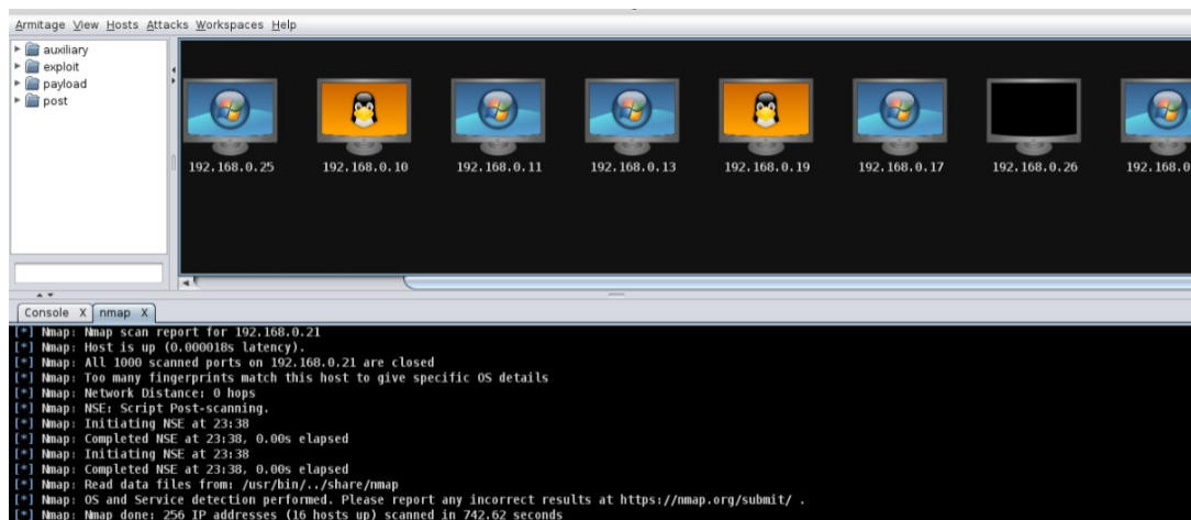
Figura 10. Escaneo de la red mediante herramienta armitage. Imagen propia.
