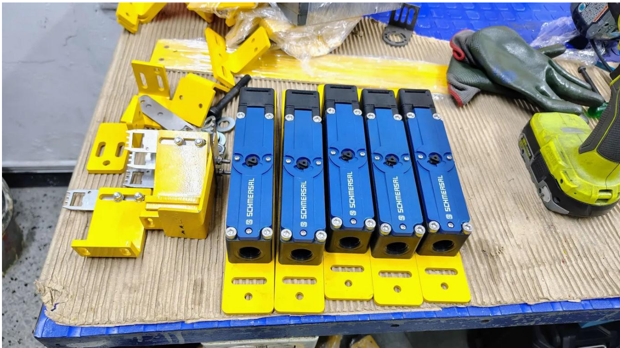
Fig. 88 chapas fabricadas por corte laser, doblado, pintadas en ral 1003 y llave AZM150
