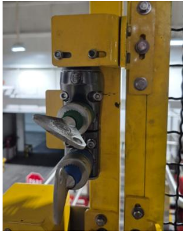
Fig. 106 Llave atrapada en puerta pivotante
