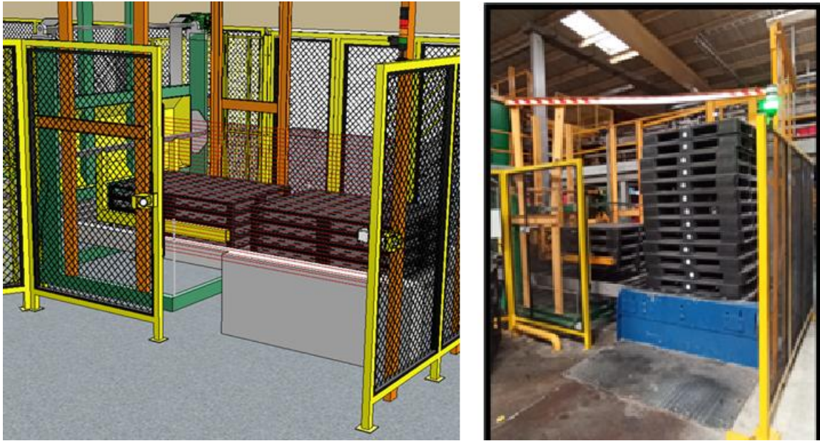
Fig. 22 Propuesta para el acceso del montacargas
