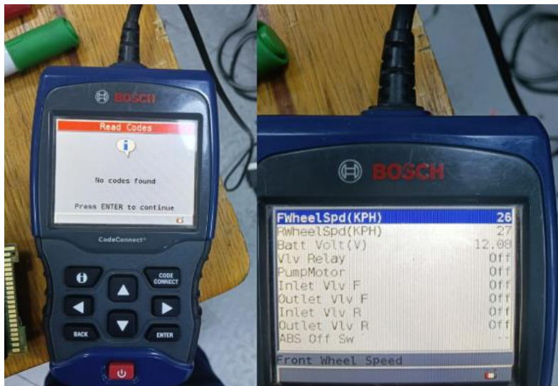
Fig. 20. Lectura de códigos de error y parámetros en vivo del tablero.
