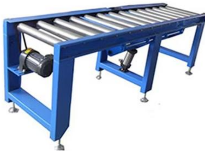
Fig. 9. Mesa transportadora de rodillos
