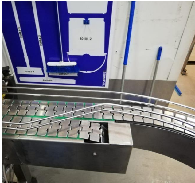
Fig. 11. Mesa transportadora por cadenas Table Top
