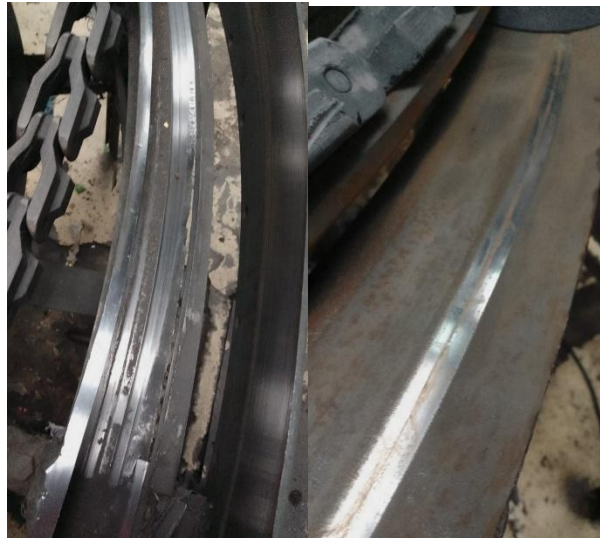
Fig. 26. Desgaste de platina A36 luego de 12 semanas y desgaste de platina Brinell 450 luego de 6 semanas
