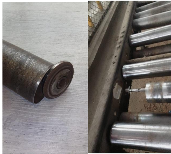
Fig. 28. Modo de falla de los rodillo y desgaste en los agujeros para eje del chasis
