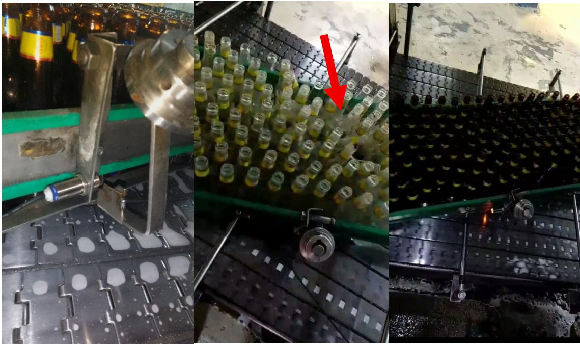
Fig. 30. Adaptación en palometa y generación de botella caída por vacíos
