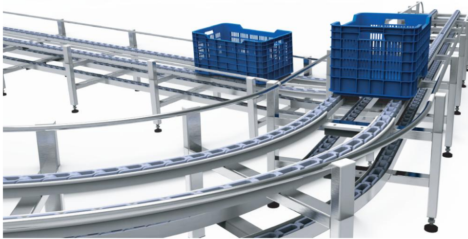
Fig. 10. Mesa transportadora de cadenas cardánicas
