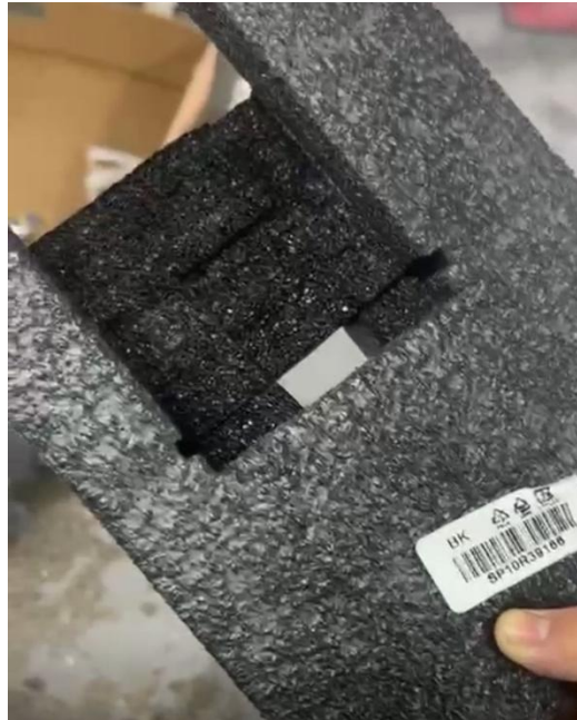
Figura 4. Espuma de Polietileno usada en embalaje. Elaboración propia, 2025.
