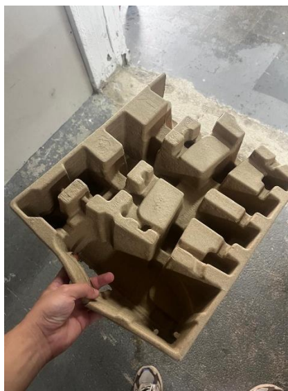
Figura 1. Cartón reprocesado usado para el embalaje de equipos de cómputo. Elaboración propia. 2025
