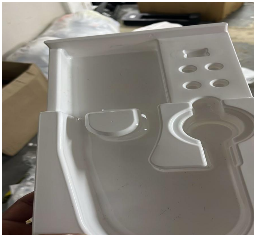
Figura 2. HIPS usado en embalaje. Elaboración propia 2025.
