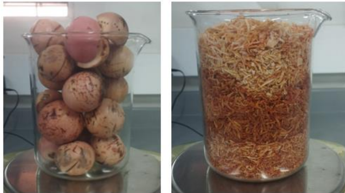
Figura 12. Semillas antes (izquierda) y después (derecha) del proceso del rallado
