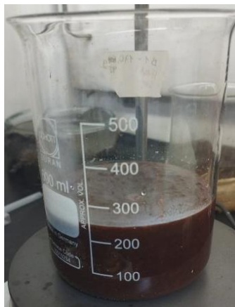
Figura 15. Cambio de coloración de la mezcla durante la digestión de la lignina con NaOH.
