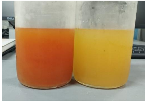
Figura 14. Agua residual de la extracción húmeda. Muestra sin NaHSO 3 (izquierda), muestra con NaHSO 3 (derecha).
