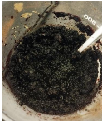
Figura 17. Digestión de la lignina de las cáscaras del aguacate para la obtención de celulosa.
