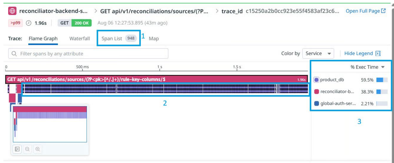
Fig. 4. Análisis de traza en Datadog APM para el endpoint rule-key-columns con indicadores de N+1 (1, 2, 3)
