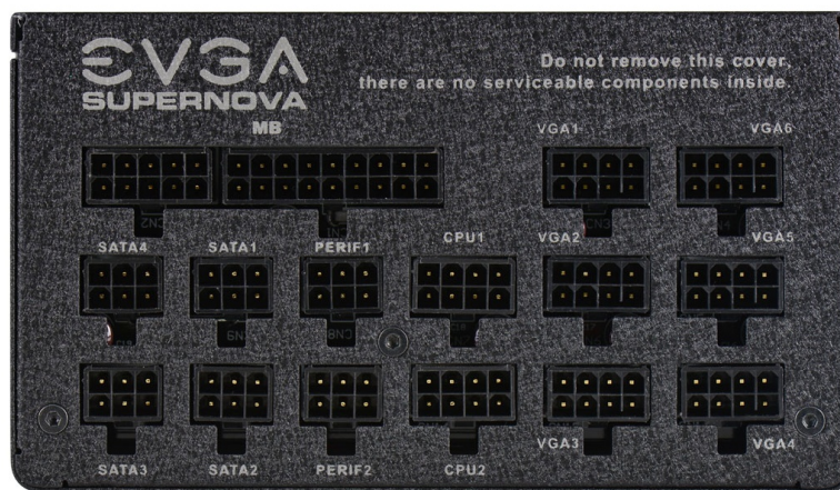
Fig. 6. Puertos disponibles en la fuente de alimentación EVGA 1200P.
