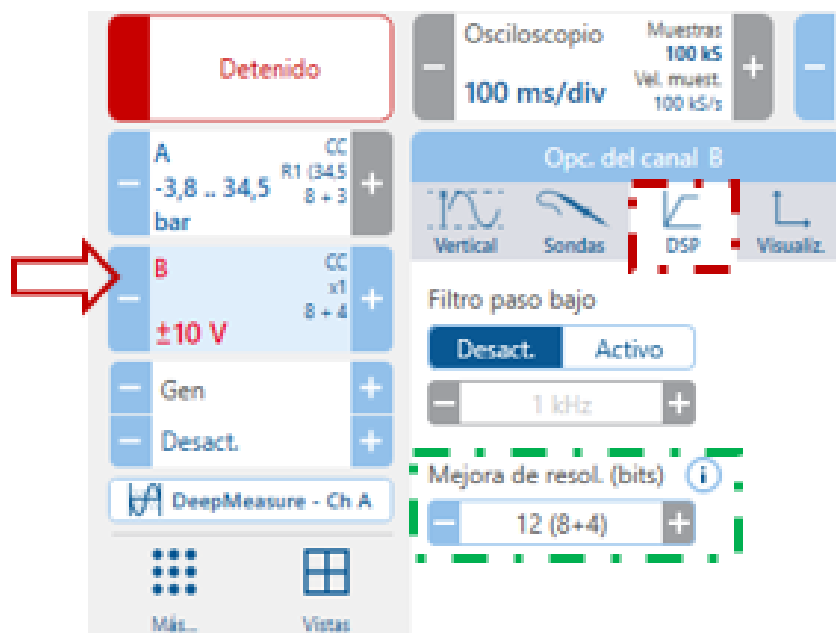
Fig. 86. Configuración del Canal B , para medición de Inyección - Pestaña DSP .
