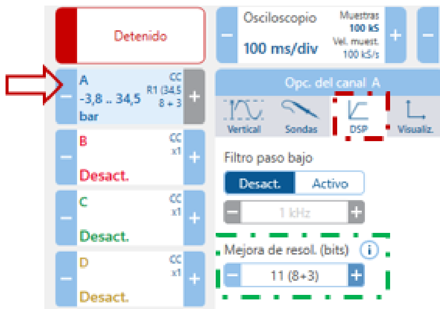
Fig. 78. Configuración del Canal A , para medición de Presión - Pestaña DSP .
