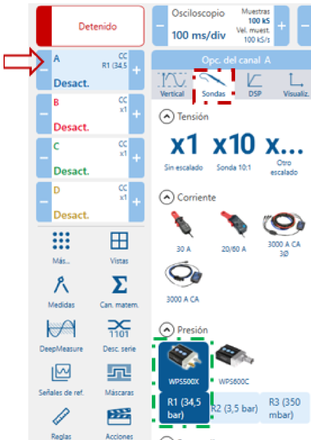
Fig. 76. Configuración del Canal A , para medición de Presión - Pestaña Sondas .
