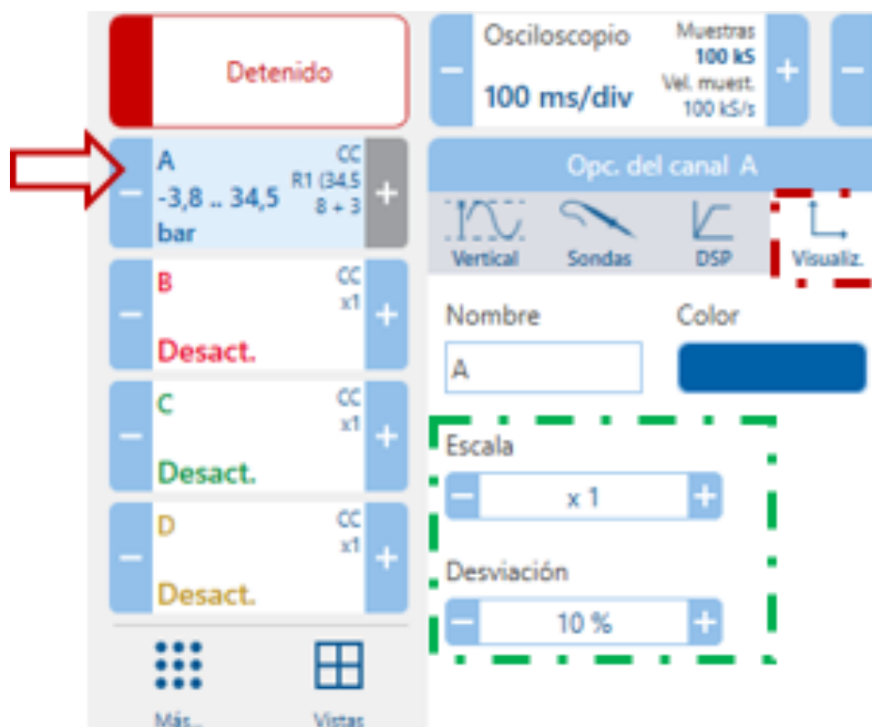
Fig. 79. Configuración del Canal A . Medición de presión - Pestaña Visualización .
