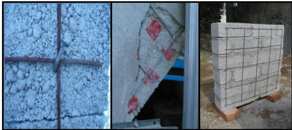
Figura 6: Procedimiento de colocación de anclajes, plástico y malla en cada murete (Mendoza Pérez J C S, et al., 2010).
