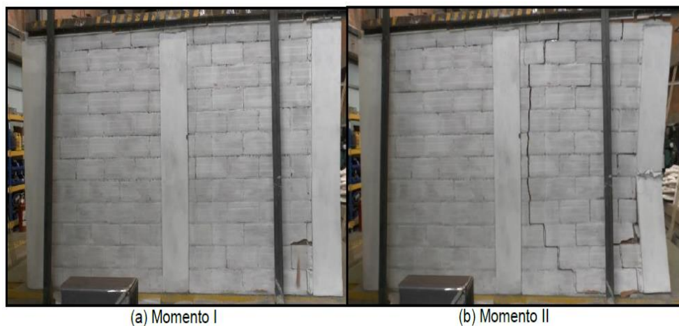
Figura 5: Momento de la falla del muro del ensayo 9-T2-1-408-0-R, vista norte
