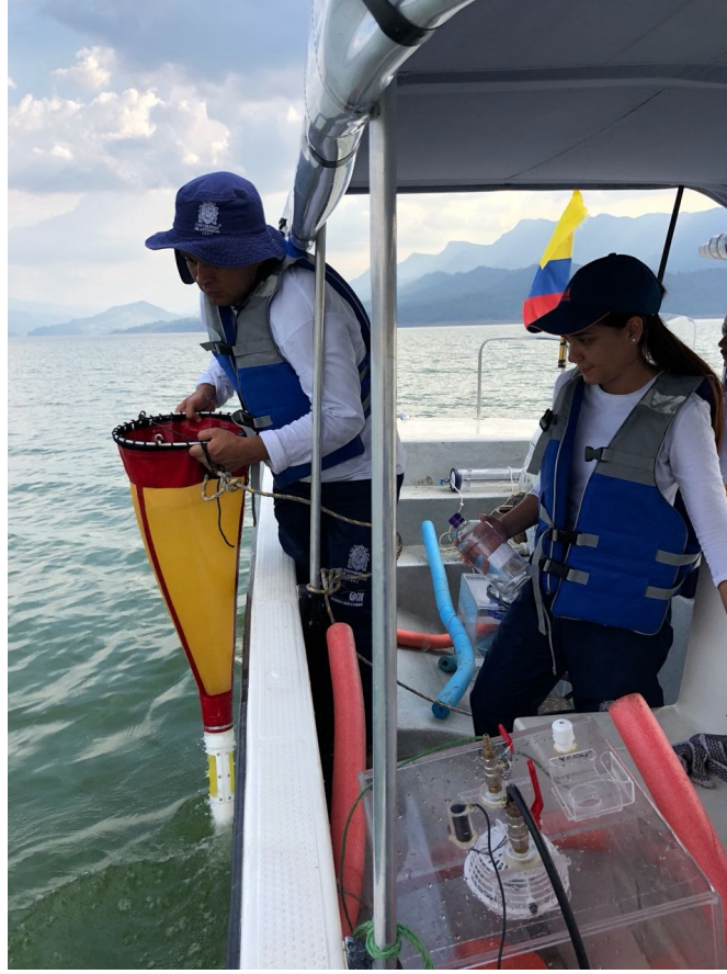
Figura 5.2: Red de plancton empleada en la toma de muestra para la cuantificación de cianobacterias planctónicas.
