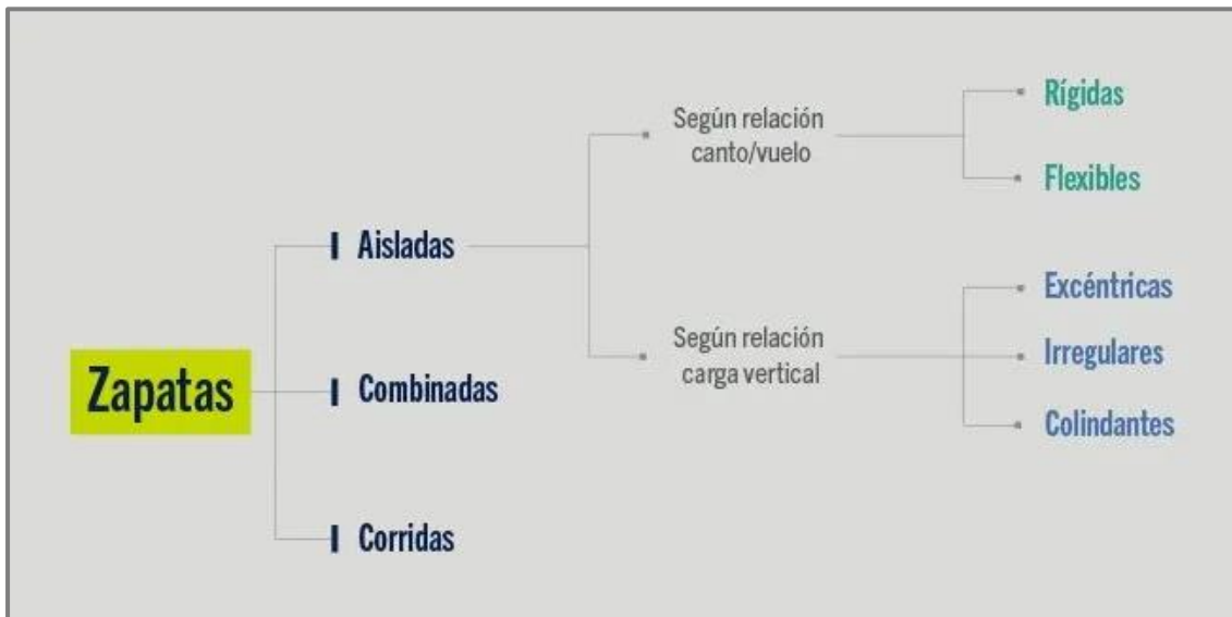
Ilustración 7 Clasificación general de las zapatas. Fuente: ASOCRETO (Muñoz, 2015).
