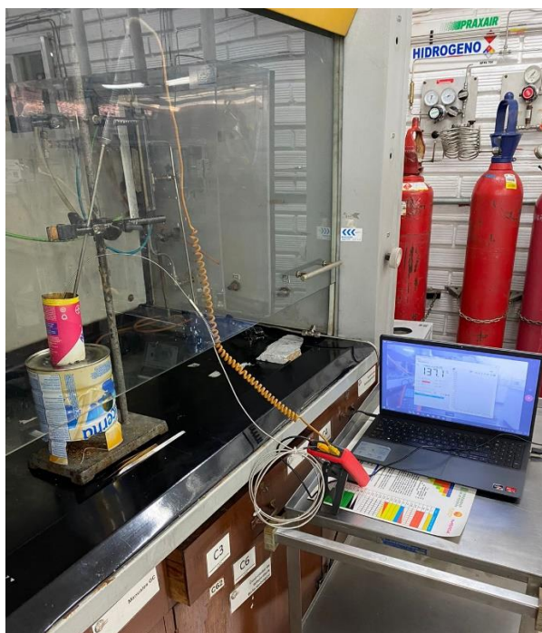
Fig 6. Síntesis de biochar - Montaje experimental de recolección de datos de temperatura
