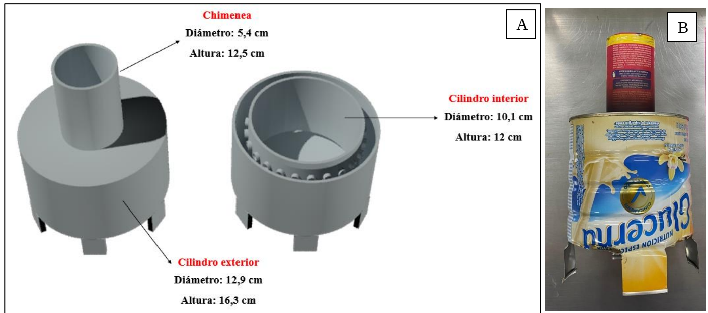
Fig 26. Diseño microgasificador tiro ascendente A) Software AutoCAD B) Diseño real utilizado
